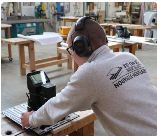
L'Oakbot : machine-outil portable de type CNC spécialement conçue pour l'usinage précis des tenons et mortaises, éléments clés dans les assemblages de charpente et menuiserie.
